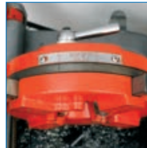
Selección de la profundidad de la rosca. Thread depth. Sélection de la profondeur du filetage.
