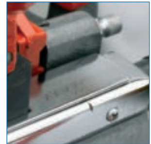
Selección de longitud de rosca. Thread length selection. Sélection de la longueur du filetage.
