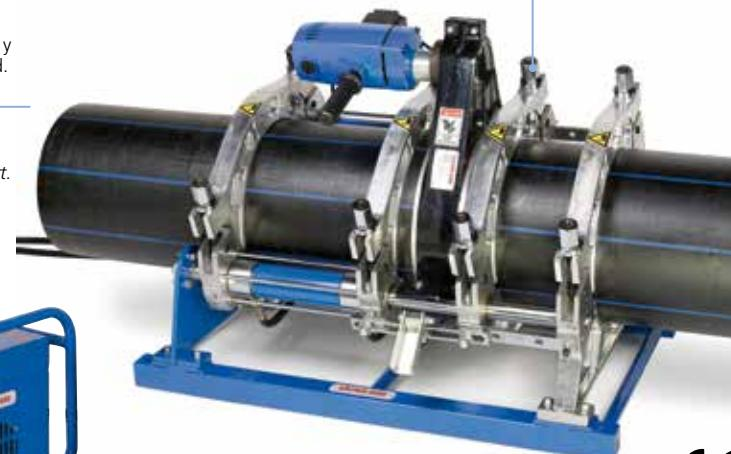
Máquina base. Rígida construcción que asegura una exacta alineación
