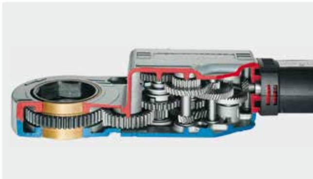
Gran reducción de la transmisión merced a su tren de engranajes con siete ejes paralelos montados sobre rodamientos de bolas, que permiten una transmisión constante del nivel de potencia.
